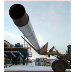
Труба с предварительной изоляцией: Пирогель делает возможной предварительную изоляцию и последующую перевозку трубы.
