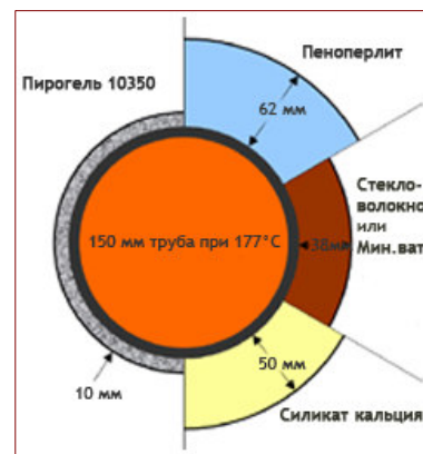
Все четыре модели демонстрируют одинаковый уровень теплоизоляции (130 Btu/hr-ft)
